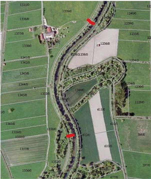
Abb. 11: Entfernter Auwald im Zuge der Deichfreistellungsmaßnahmen zu Jahresbeginn 2011. Die roten Markierungen geben das nördliche und das südliche Ende des Freistellungsbereichs wieder. Dazwischen wurde an der westlichen Ammerseite der Auwald in seiner Eigenschaft als LRT 91E0\* entfernt. Luftbild und Flurkartengrundlage SW 12/14, jeweils Copyright Bayer. Landesamt für Vermessung und Geoinformation.
